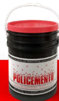
**POLICEMENTO MC B** es un producto líquido color blanquecino, cuya característica principal una vez pulverizado sobre la superficie del hormigón fresco, es la formación de una película homogénea, uniforme, continua y flexible, que actúa de barrera contra la evaporación brusca del agua. De tal modo, que el hormigón completa su fraguado y curado en presencia de la humedad necesaria para la total hidratación del cemento.
